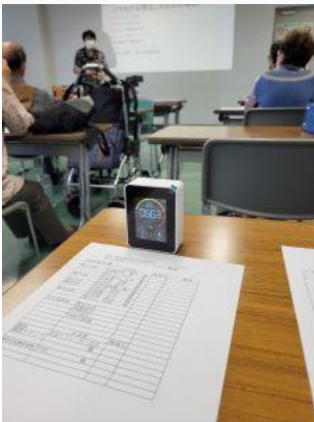
換気の目安となる CO2 濃度測定 800PPM で警報設定→窓開け換気
