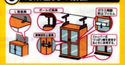
レイアウトを工夫したうえで、対策器具を設置! ポール式(つっぱり棒)・マット式など壁を傷付けにくい対策器具も!
