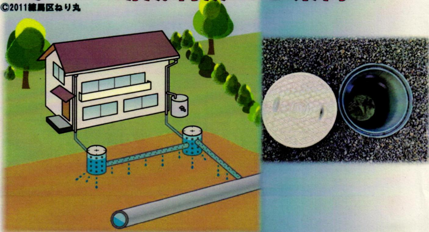
宅地内に浸透ます等の雨水浸透施設を設置することで、河川や下水道に流れる雨水を減らし、浸水被害が軽減されます。
