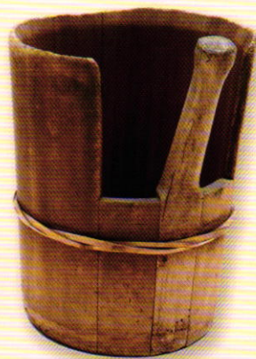
かき桶 醤油や味噌の原料である大豆や小麦を貯蔵容器から取り出す道具。
